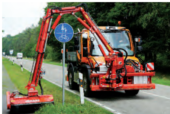
DUA 800 – Teleskoparmen gør det muligt at køre hen over vejskilte.
