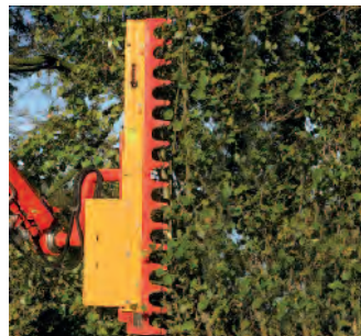
AWS 13 / 22 Gren- og hækkesaks Arbejdsbredde: 1300 / 2200 mm Klippetykkelse: op til 110 mm Vægt: ca. 160 kg / 230 kg
