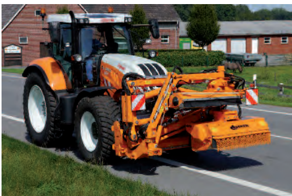
Klippekombination MK i transportstilling på Steyr
