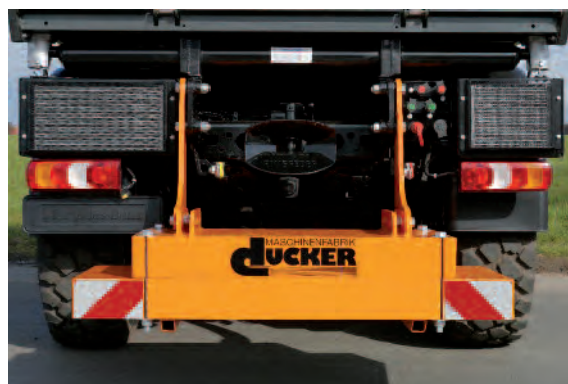
Kontravægt i monteringsbeslagene på Unimog
