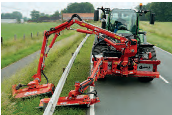
Klippekombination MK bestående af DUA 700 og RSM på Fendt-traktor ved samtidig klipning bag og under autoværn
