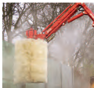
SWA 900 Skiltevaskeanlæg Børstebredde: 900 mm Børsteomdrejningstal: 250 o./min. Vægt: 155 kg
