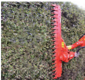
HSL 15 Hækkeklipper Arbejdsbredde: 1500 mm Klippetykkelse: op til 30 mm Vægt: ca. 85 kg
