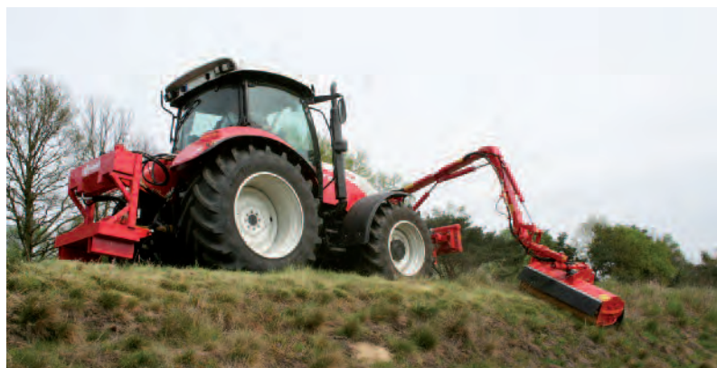
UNA 500 i delt konstruktion (hydraulikaggregat i bagmontering)
