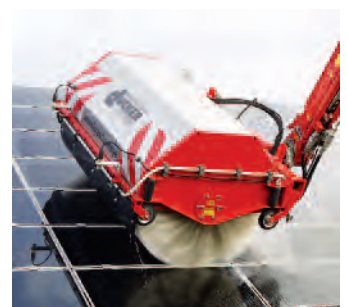
TWA 18 Tunnelvaskeanlæg Børstebredde: 1800 mm Børsteomdrejningstal: 280 o./min. Vægt: 285 kg
