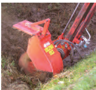
GSF 600 Grøfterenser Rensdiameter 600 mm Rotoromdrejningstal: 800 o./min. Vægt: 230 kg
