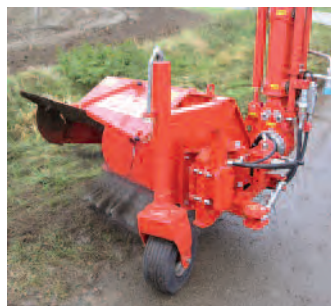
RWB 600 Radialukrudtsbørste Arbejdsbredde: 600 mm Rotoromdrejningstal: 150 o./min. Vægt: 320 kg
