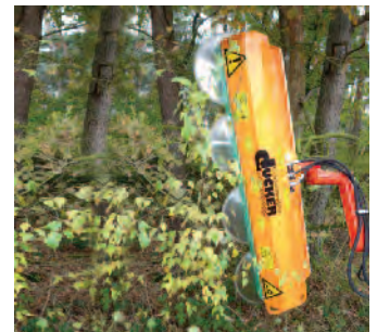
LPS 20 Profilsav Arbejdsbredde: 2000 mm Savklingens omdrejningstal: 2600 o./min. Vægt: ca. 220 kg
