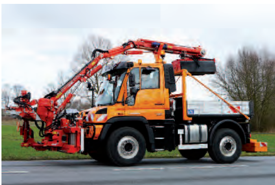
MK 25 i transportstilling bagud med parkeringsramme
